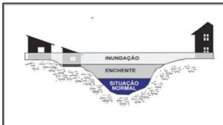
Figura 4. Perfil esquemático dos processos de enchente e inundação
