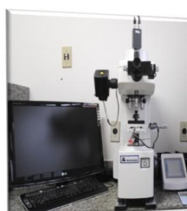
Microduromômetro Buehler Carga 5g; Tempo 10 segundos
