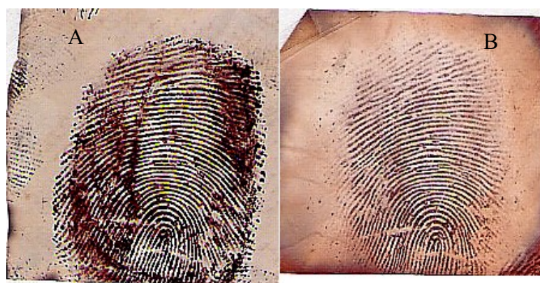
Figura 17. Coleta direta de impressão dígito-papilar utilizando celulose bacteriana impregnada com nitrato de prata. Em (A), impregnação por 3 minutos. Em (B) impregnação por 1 hora.
