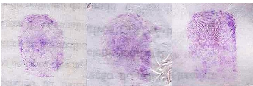
Figura 13. Revelação de impressões dígito-papilares em membrana seca utilizando ninidrina e seu tratamento utilizando o software ImageJ.
