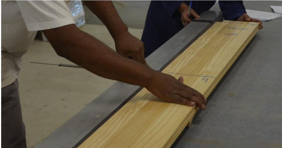
Figura 52 - Medição do arqueamento do batente
