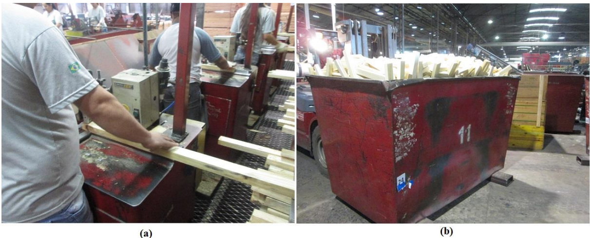
Figura 38 - Processo de destopo: (a) entrada das lamelas com defeitos e (b) tambor com estoque de blocks
