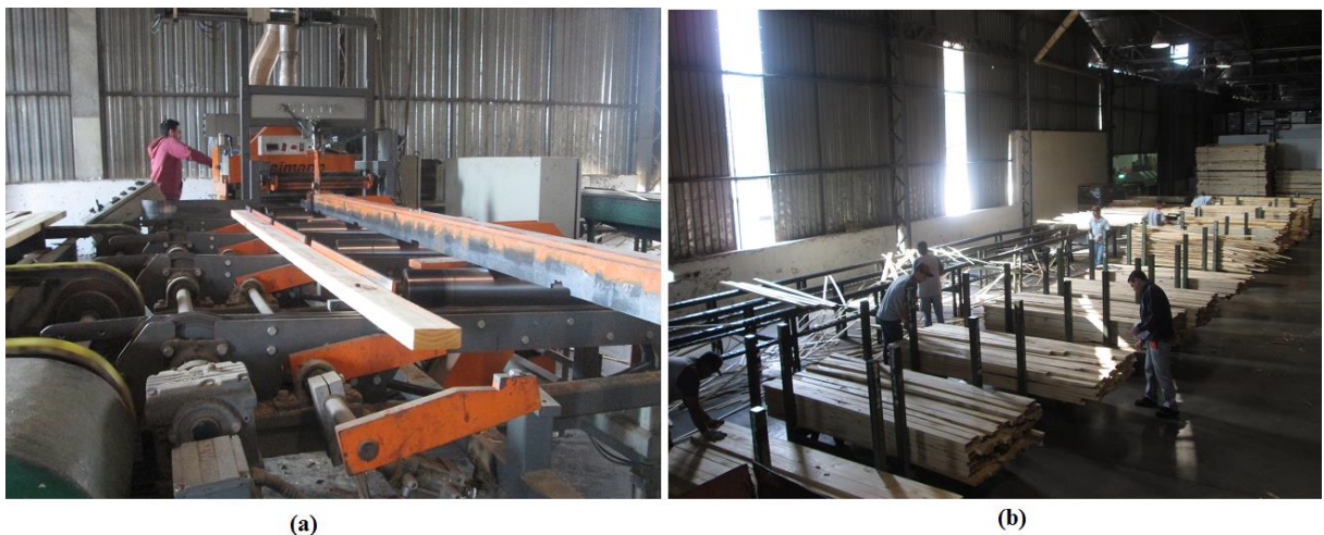
Figura 37 - Processo de refilo: (a) entrada das tábuas e (b) saída e classificação das lamelas em diversas larguras
