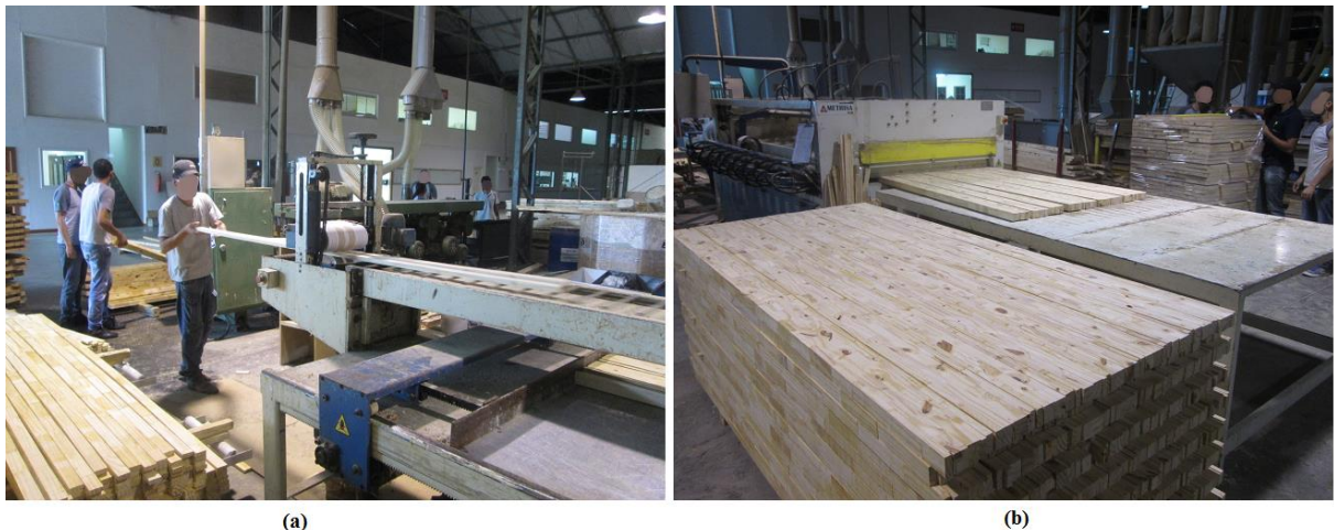
Figura 40 - Processo de prensagem e colagem: (a) aplicação do adesivo e (b) saída e estoque dos painéis
