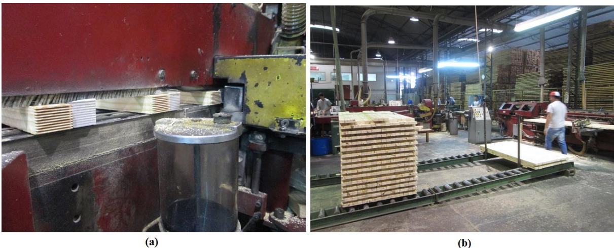
Figura 39 - Processo de finger : (a) usinagem de finger joint nos blocks e (b) saída dos blanks
