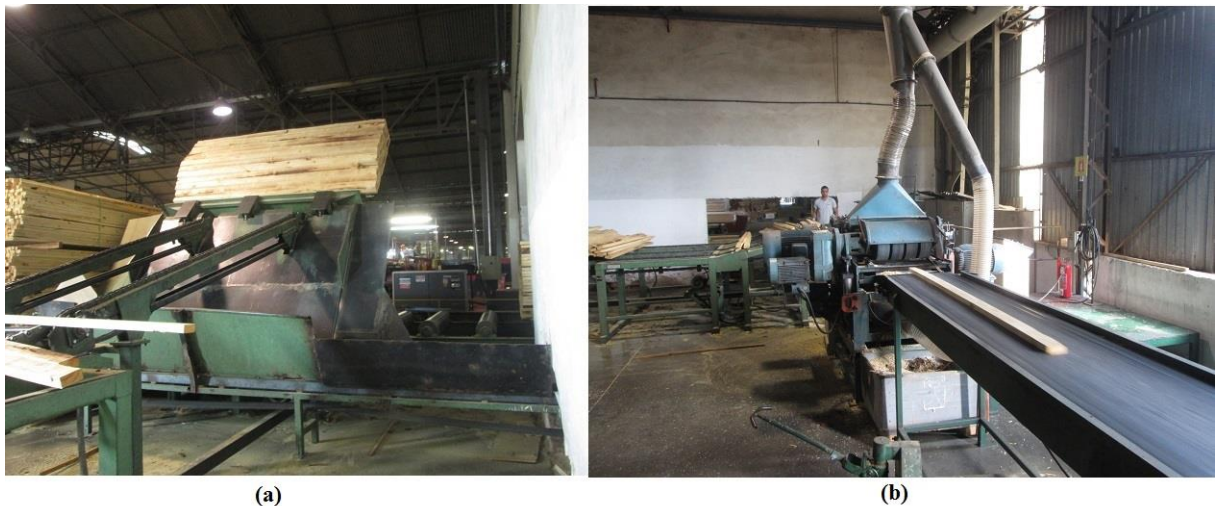
Figura 36 - Processo de aplainamento: (a) entrada das tábuas com 36 mm de espessura e (b) saída com 33 mm
