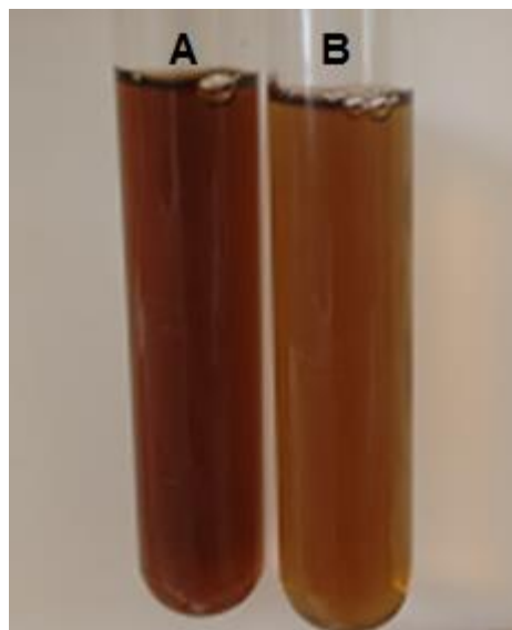
Figura 21. (A) Amostra bruta (B) Amostra bruta após filtração com carvão ativado.
