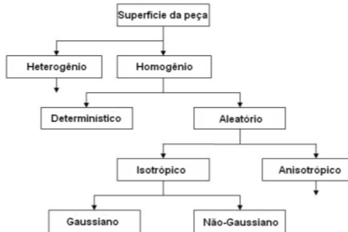
Figura 2.3- Topologia de superfícies, segundo Bhushan (2001)
