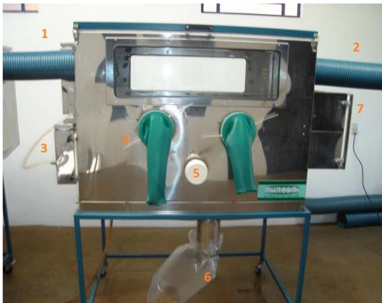
Figura 3. Modelo do isolador: (1) entrada de ar do sistema, (2) saída de ar, (3) reservatório de água, (4) luvas de borracha para manipulação interna, (5) orifício para conexão com outro isolador (contato naso-nasal), (6) saco para a coleta de dejetos, e (7) caixa de passagem, dotada de portas interna e externa.
