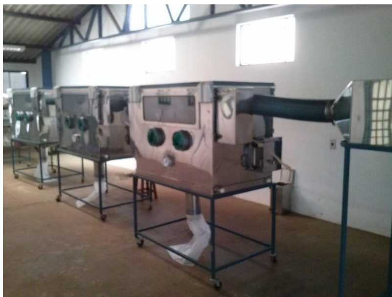
Figura 4. Imagem fotográfica ilustrando a disposição dos isoladores para avaliação da transmissão aerógena. Jaboticabal, SP, 2015.
