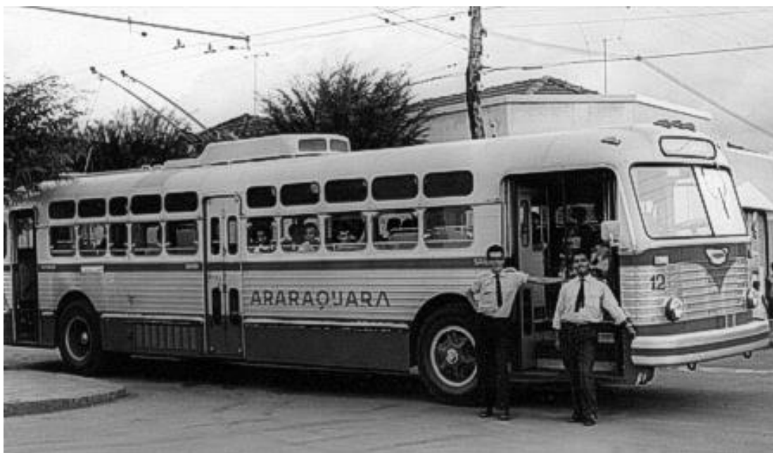
Foto de 1965 mostra o trolebus nº 12, que depois passou a circular com a numeração 15. Na foto, o cobrador Antonio Aparecido de Oliveira e o motorista Ramiro Alves Neto. Carroceria: Grassi Chassi: Villares Equipamento elétrico: Villares Mecânica: Tink
