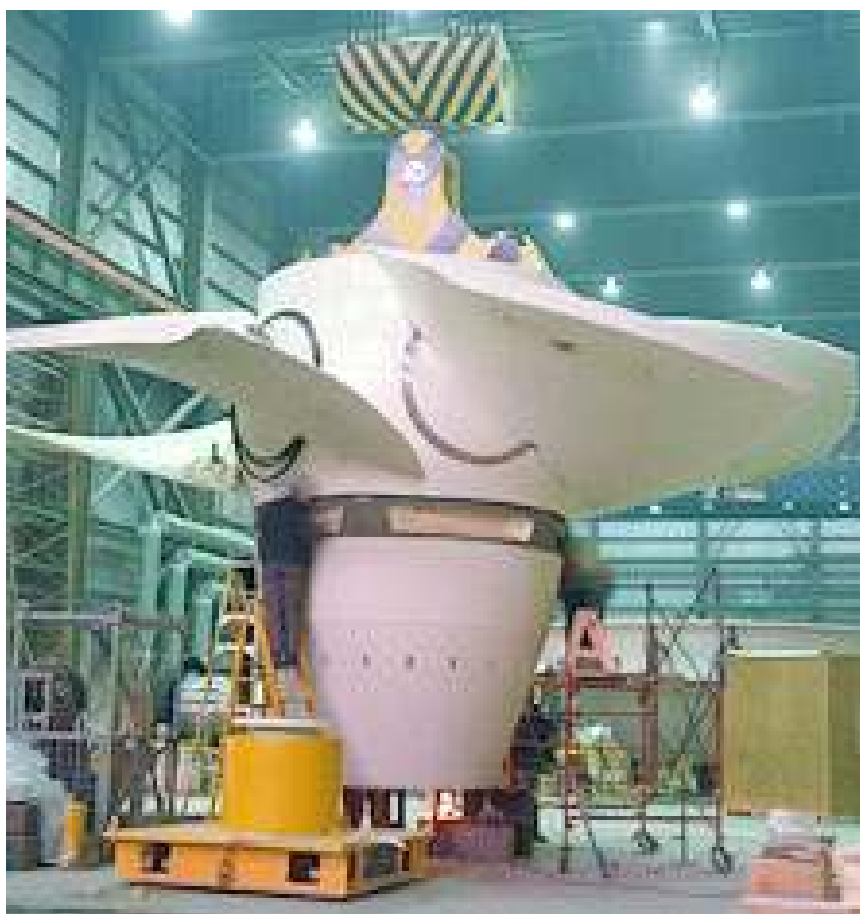
Figura 18 – Rotor de turbina Kaplan.
