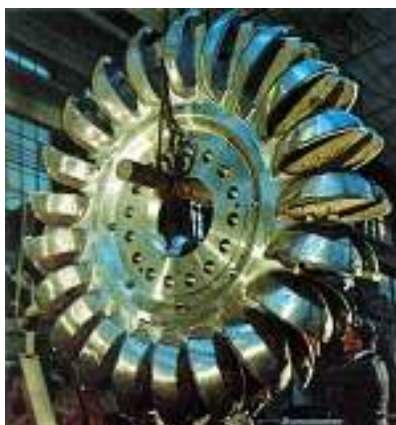
Figura 4 – Rotor de turbina Pelton.
