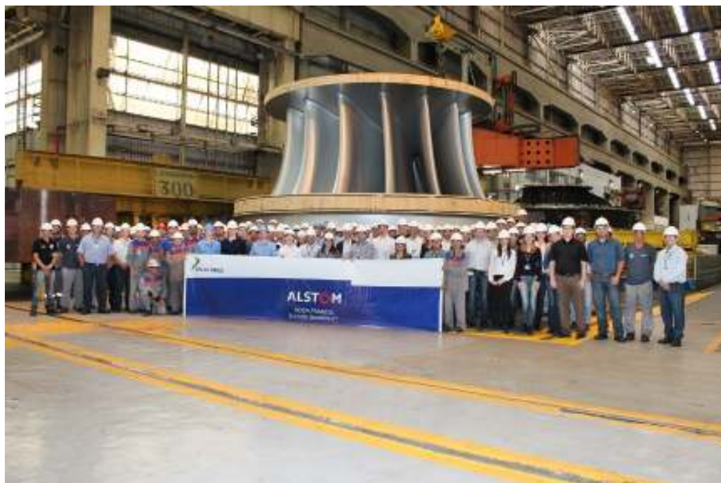
Figura 16 – Rotor de turbina Francis.
