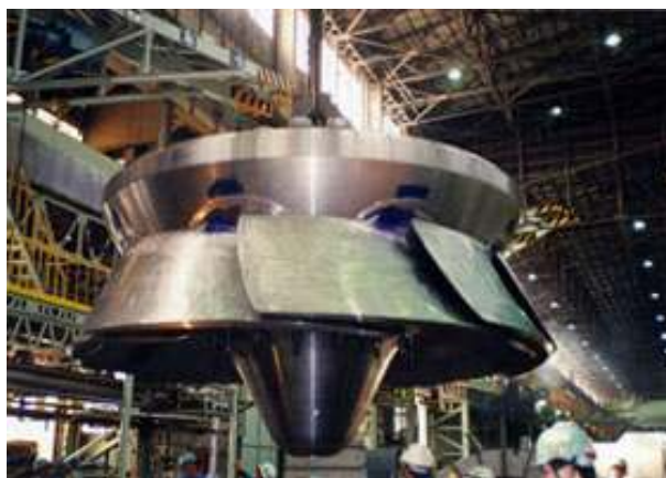
Figura 7 – Rotor de turbina Deriaz.
