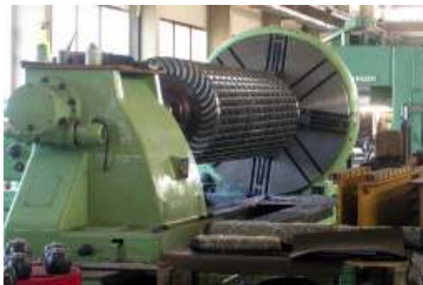
Figura 8 – Rotor de turbina de Fluxo Cruzado.
