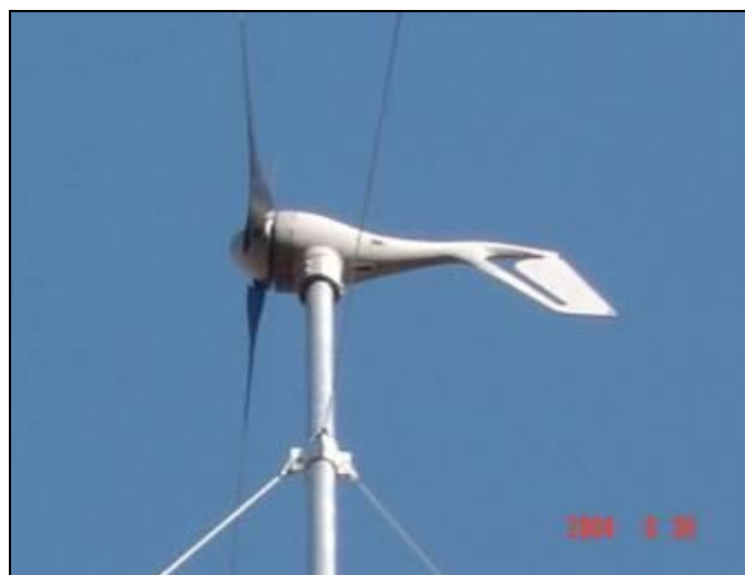
Figura 7. Aerogerador AIR-X com potência nominal de 400W.
