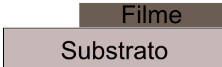
Fig. 14 – “Degrau” entre filme e substrato para medição da espessura
