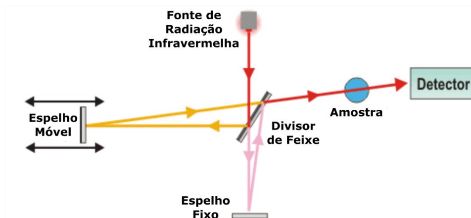
Fig. 10 – Esquema do funcionamento de um espectrômetro infravermelho por transformada de Fourier
