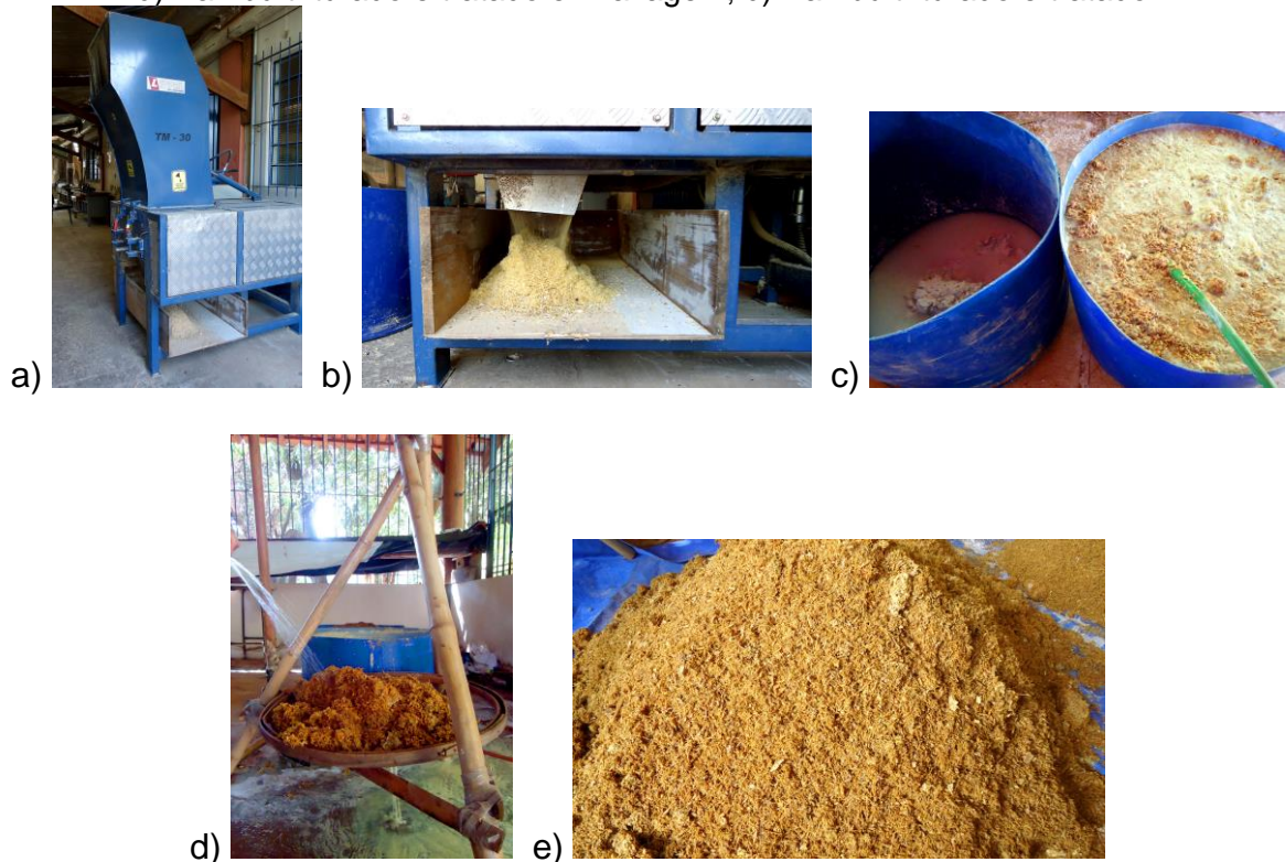
Figura 27. a) Triturador; b) Bambu sendo triturado; c) Bambu triturado em tratamento; d) Bambu triturado e tratado em lavagem; e) Bambu triturado e tratado.
