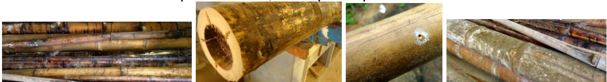
Figura 22. Mudança de cor, alteração física, ataque por brocas e aparecimento de fungos, respectivamente, da esquerda para a direita.
