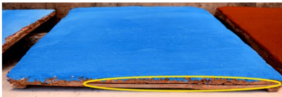
Figura 138 – Teste 3: Trinca destacada em amarelo.
