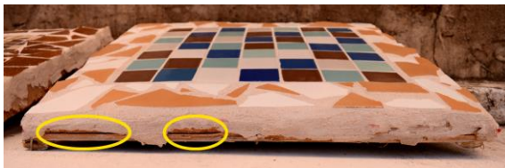
Figura 140 – Teste 5: Trincas destacadas em amarelo.
