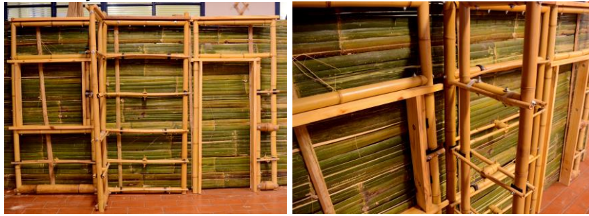
Figura 93. Simulação 2 de fechamento com os modelos em escala 1:2 dos painéis.
