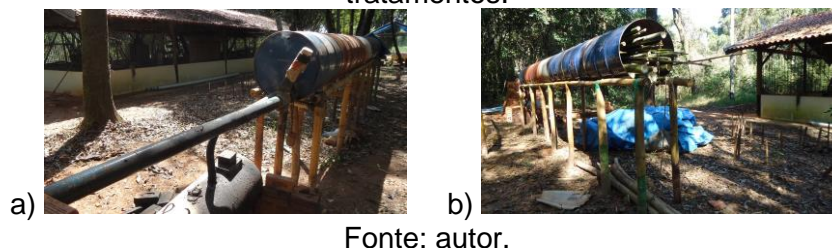
Figura 9. a) Vista da junção entres a parte traseira dos tambores com as chaminés dos fornos; b) Colmos de bambus alojados dentro dos tambores para realização dos tratamentos.
