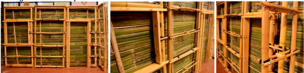
Figura 92. Simulação1 de fechamento com os modelos em escala 1:2 dos painéis.
