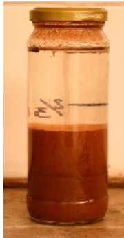
Figura 25. Teste do vidro com solo classificado como argila.
