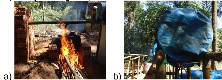
Figura 18. a) Vaporização da água; b) Local de armazenamento dos colmos para tratar.
