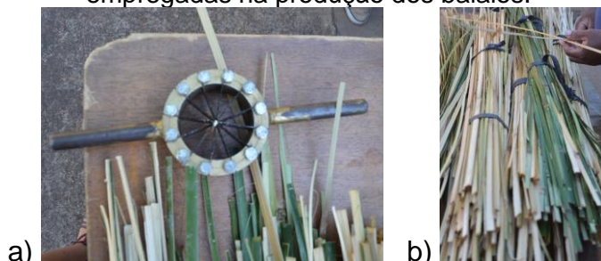
Figura 2. Rachador radial utilizado para confecção de tiras de bambu; b) tiras de bambu empregadas na produção dos balaios.
