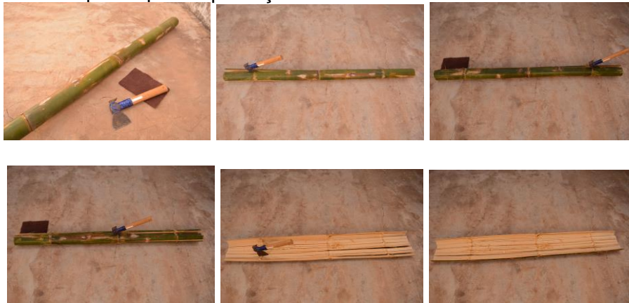
Figura 28. Passo-a-passo para a produção de esteiras com colmos de bambus em natural.
