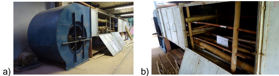
Figura 21. a) Estrutura do túnel de vento; b) Secagem em túnel de vento dos bambus colhidos e tratados.
