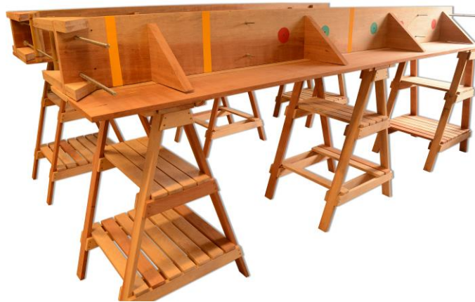
Figura 107. Lado direito externo do gabarito com as cores e formas usadas para indicar a montagem dos painéis modulares.
