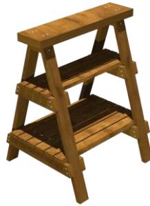
Figura 98. Cavalete utilizado na composição da bancada para apoio do gabarito.
