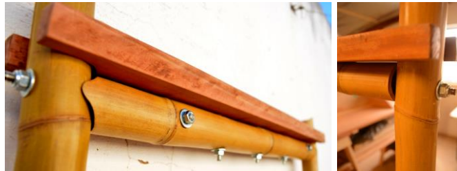
Figura 83. Teste – Elemento da estrutura mestra com boca-de-peixe adaptado, de um lado com orelha e do outro lado sem.
