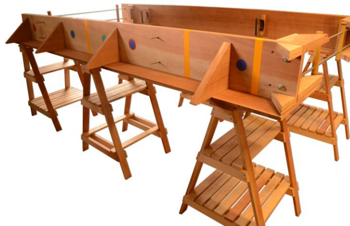
Figura 108. Lado esquerdo externo do gabarito com as cores e formas usadas para indicar a montagem dos painéis modulares.
