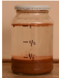
Figura 26. Teste do vidro com solo classificado como terra arenosa.
