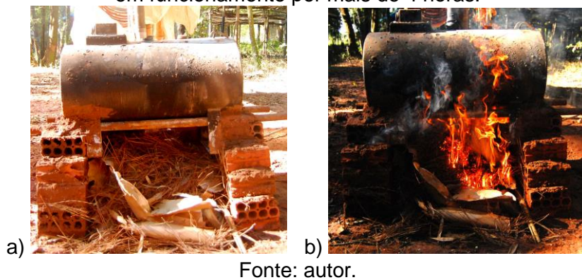
Figura 4. a) Forno construído para vaporizar a água contida no recipiente de ferro; b) Forno em funcionamento por mais de 4 horas.
