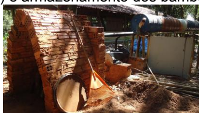
Figura 20. Sistema de tratamentos naturais – fumaça (forno grande à esquerda), vapor d'água (forno menor ao centro) e armazenamento dos bambus (tambores de ferro à direita).
