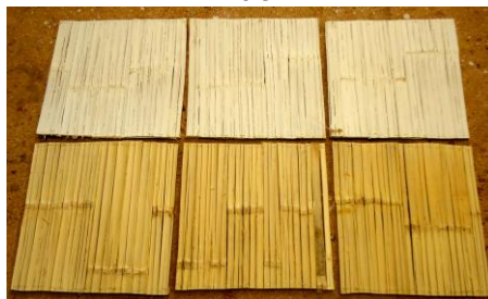
Figura 125 – Pares organizados na direção vertical, onde uma esteira leva caiação e a outra não.
