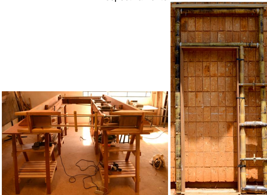
Figura 115 – Etapa da montagem do painel modular porta e seu protótipo finalizado, respectivamente.
