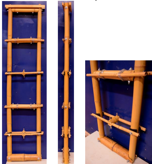
Figura 86. Modelo em escala 1:2 - painel modular conector.
