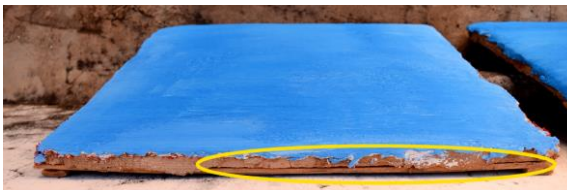
Figura 139 – Teste 4: Trinca destacada em amarelo.
