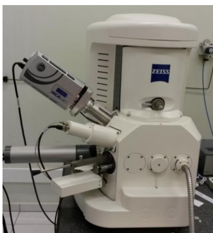
Figura 17. MEV-EDS/EBDS disponível do Laboratório de Imagens do Departamento de Materiais, FEG/UNESP.
