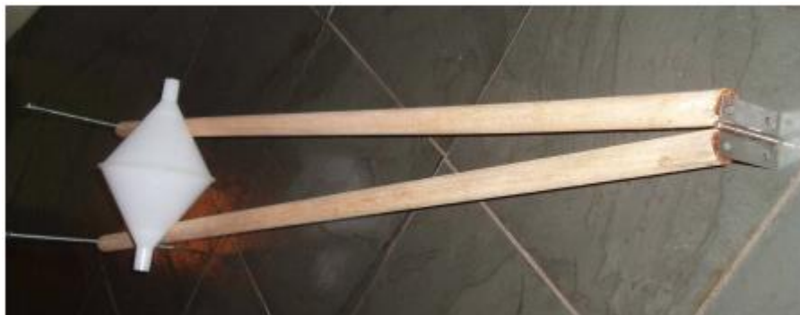
Figura 5.29 – Experimento do duplo cone criado com materiais do dia a dia.
