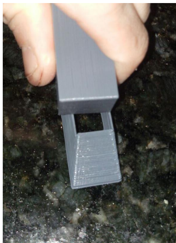
(b) Falta de encaixe devido as dimensões erradas da soalha.
