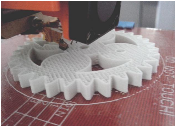
Figura 3.1 – Engrenagem sendo construída pela manufatura aditiva (impressão 3D)
