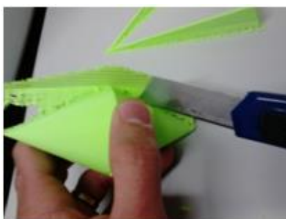
(a) Remoção da base de impressão. Fonte: Próprio autor.
