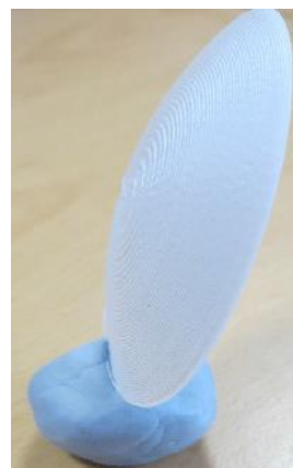
(b) Lente impressa em material solúvel em água para o estudo de eletromagnetismo no micro-ondas. Fonte:
