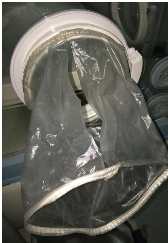
Figura 7- Incubadora neonatal com filtro sujo. Botucatu, 2016.
