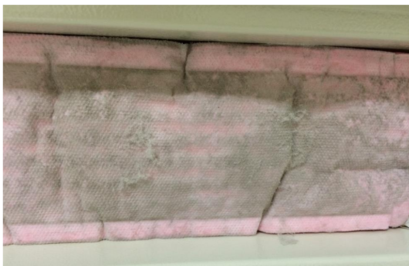
Figura 7- Incubadora neonatal com filtro sujo. Botucatu, 2016.
