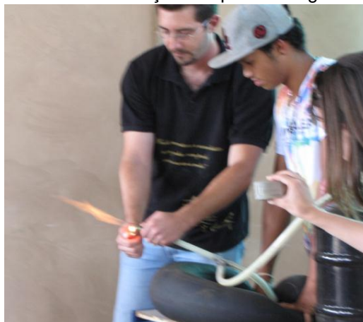
Figura 13: Demonstração da queima do gás metano
