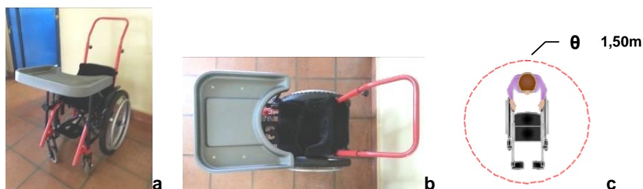
Figura 13 – Cadeira de rodas infantil 3 - Vista lateral e superior (a, b) e o Módulo da área de manobra da criança (c) 4
