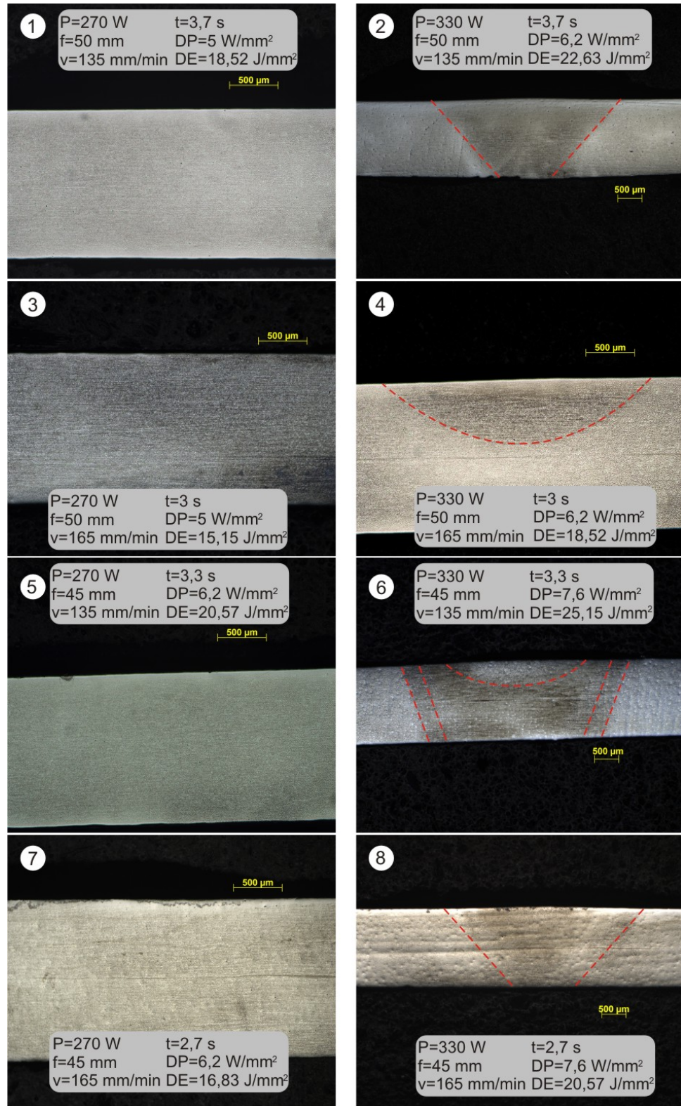
Figura 31 – Microestruturas transversais obtidas após tratamento térmico a laser, para o aço DP 600. P : potência nominal do feixe, f : desfocalização, v : velocidade de avanço, t : tempo de interação entre o feixe e material, DP : densidade de potência e DE : densidade de energia
