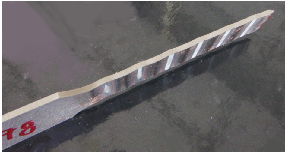
Figura 46 – Aspecto ondulado de um corpo de prova rompido, típico dos aços DP 600 e TRIP 750
