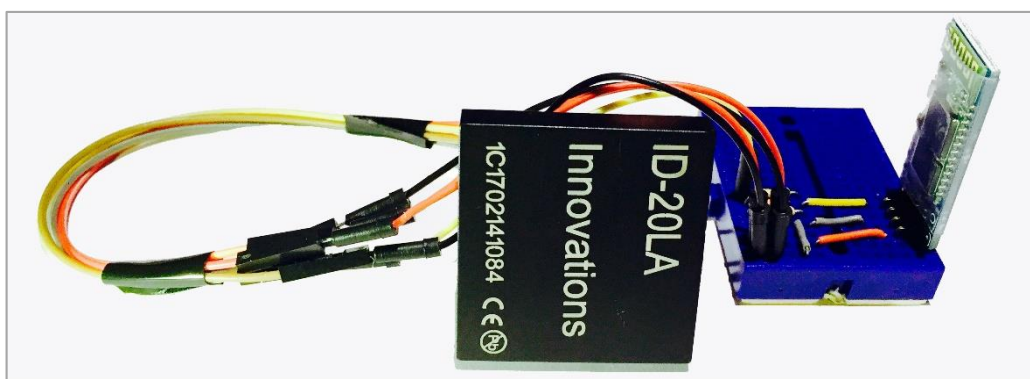
Figura 20 - Circuito ID-20LA e Bluetooth HC-06.
