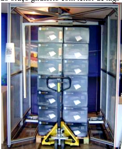
Figura 51 – Estrutura metálica contendo braço giratório com leitor de tags RFID.
