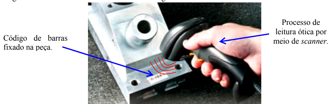
Figura 35 – Processo de leitura ótica de um código de barras.
