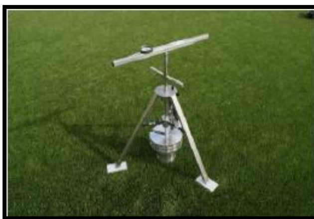
Figura 13. Equipamento utilizado na avaliação da tração superficial “Rotational Resistance Tester”
