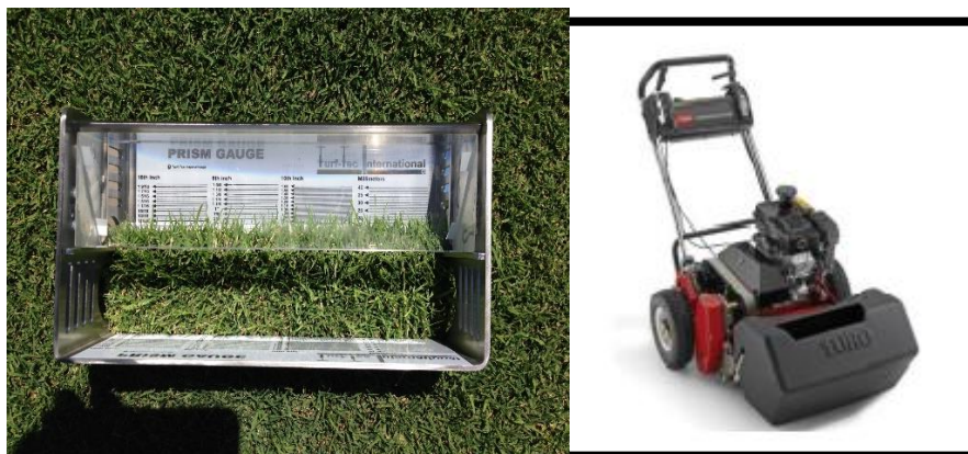
Figura 12. A- Instrumento medidor de altura de gramado “Grass Height Prism Gauge”; B- Máquina “GreenMaster 1000” da empresa Toro®.
