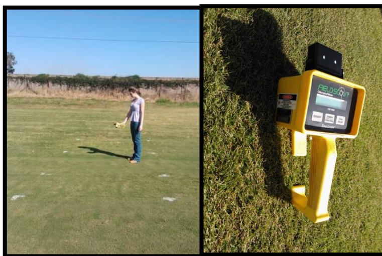
Figura 11. Aparelho utilizado para medir a intensidade de cor verde Field Scout CM-1000 Chlorophyll Meter.
