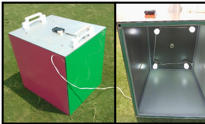
Figura 14. Equipamento utilizado para uniformização da luminosidade e da área fotografada “Light Box.”
