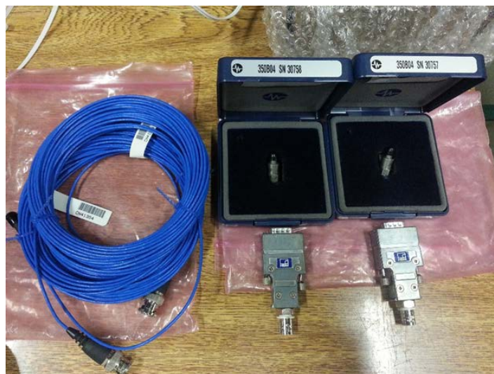
Figura 4.10 Acelerômetros, cabos coaxiais e condicionadores/amplificadores de sinal.
