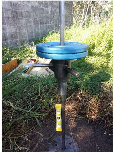
Figura 5.8 DPL com martelo e massas de halteres sobrepostas.
