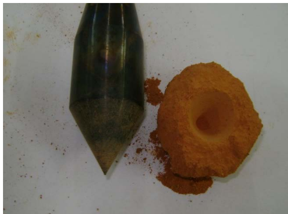
Figura 5.10 Cunha de solo compactado formada abaixo da ponteira com ângulo de ápice de 180°.
