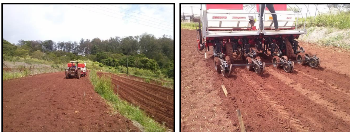
Figura 4: Realização da adubação e marcação das linhas de semeadura, com o auxílio de uma semeadora-adubadora, Botucatu 2016.
