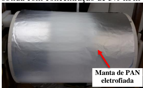
Figura 16 – Manta de PAN obtida com concentração de 5% m/m
