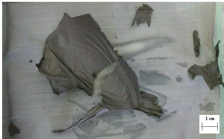
Figura 28 – Manta de PAN carbonizada
