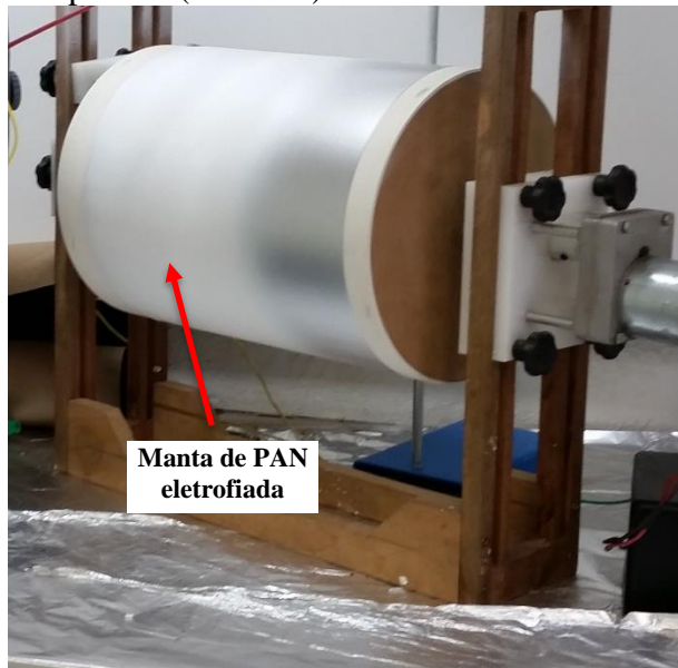
Figura 19 – PAN eletrofiada por 6 h (6% m/m)
