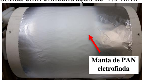
Figura 18 - Manta de PAN obtida com concentração de 4% m/m
