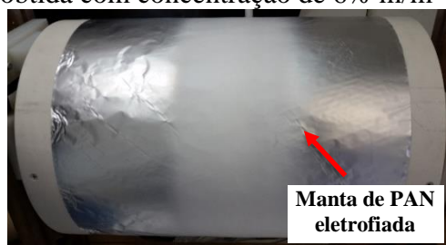
Figura 17 - Manta de PAN obtida com concentração de 6% m/m
