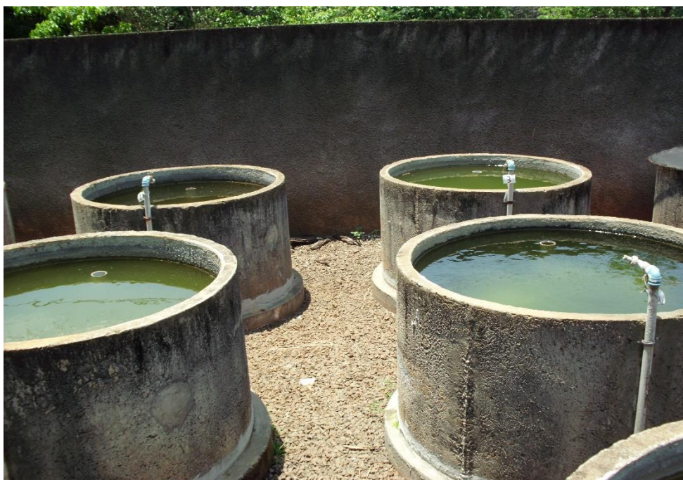
Figura 1. Microcosmos de concreto com capacidade para 600 litros utilizados no experimento 1.
