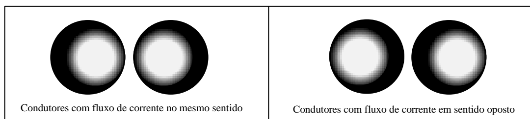
Figura 12 – Efeito da frequência e proximidade na capacidade de condução de corrente
