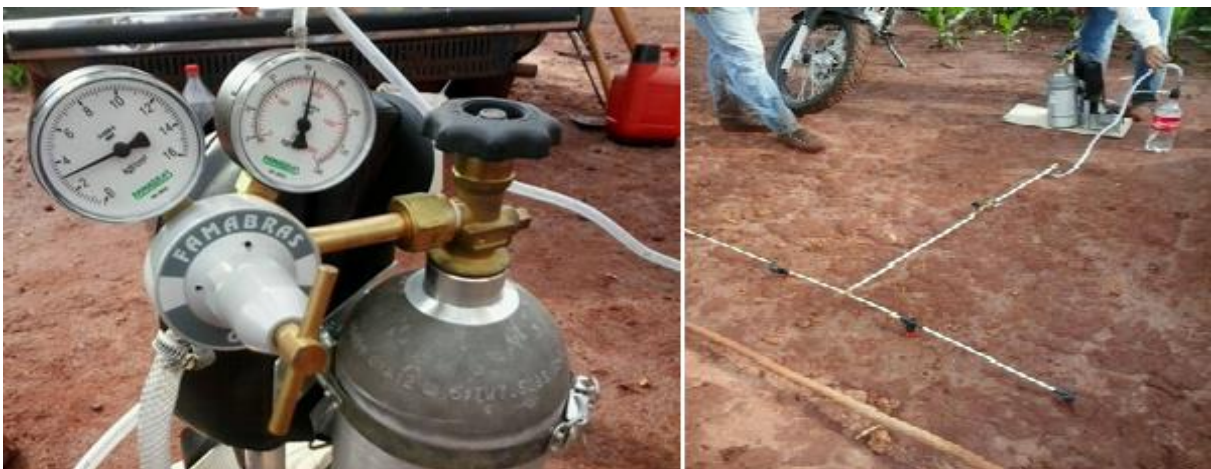
Figura 3 - Bomba costal de \text{CO}_2 pressurizada com quatro pontas de pulverização utilizada na adubação foliar do milho primavera/verão 2013.
