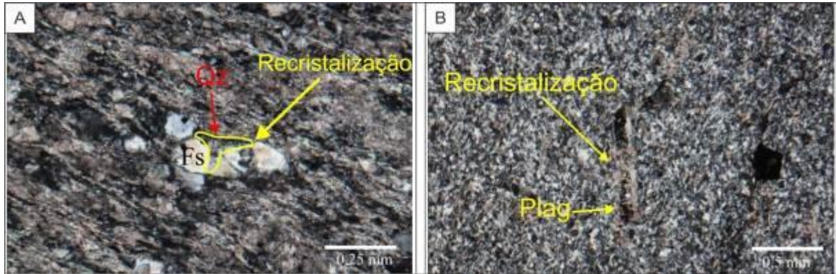
Figura 44. A) Fotomicrografia da lâmina polida AT202-3, metandesito proveniente de furo de sondagem AT202-3, mostrando microboudinagem de cristal de Feldspato, sendo preenchido por cristais de quartzo recristalizados (Qz: quartzo; Fs: feldspato). B) Fotomicrografia da lâmina petrográfica JA13-189 exibindo saussuritização do cristal de plagioclásio, bem como recristalização deste para micas brancas (Plag: plagioclásio). Ambas as fotos em polarizadores cruzados.
