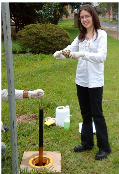
Figura 47 – Bailer com LNAPL retirado de um poço de monitoramento próximo do local de vazamento.
