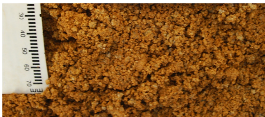
Figura 78 – Areias com película de óxidos e hidróxidos de ferro, poço RE-PM-64.
