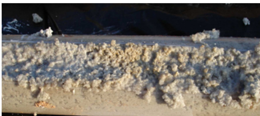
Figura 79 – Areias com quantidades praticamente isentas de óxidos e hidróxidos de ferro, poço RE-PM-83.
