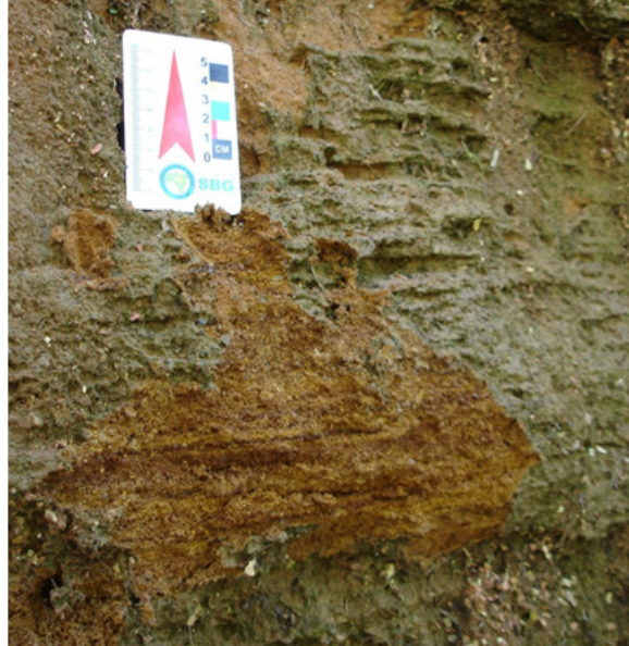
Figura 36 – Depósitos de canal com estratificação cruzada de baixo ângulo (Afl. Modelo).
