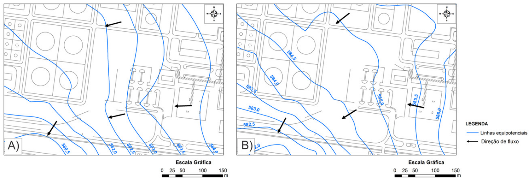
Figura 41 – Mapas potenciométricos gerados a partir da mensuração das cotas do nível d'água nos dias: A) 16/12/2007 e B) 24/05/2012.
