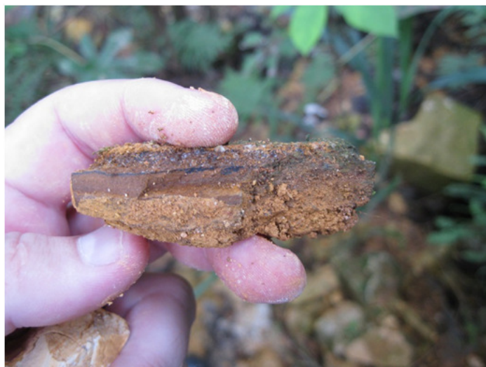
Figura 77 – Couraça laterítica retirada de afloramento pertencente à mesma unidade geológica contaminada pelo querosene de aviação. As couraças lateríticas são comumente observadas no contato entre corpos arenosos e lamíticos.
