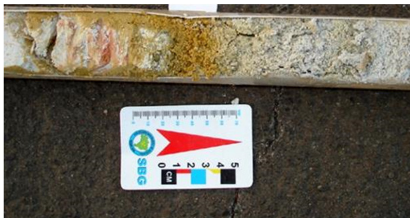
Figura 27 – Arenito médio a grosso de fácies de canal, sobreposto, em contato erosivo, a silito da Formação Rio Claro (amostra recuperada do poço RE-PM-77; profundidade de 13,9 m).
