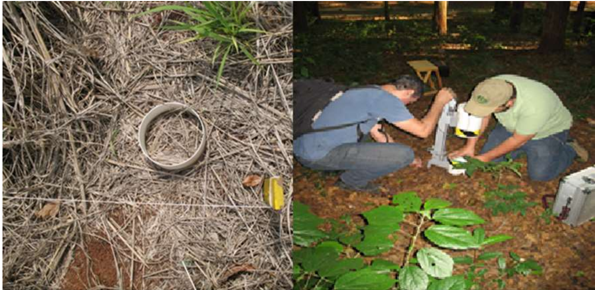
FIGURA 13. ANEL DE COLETA INSTALADO NO TALHÃO 15, CÂMARA SENDO FIXADA NO ANEL NO TALHÃO 23.
