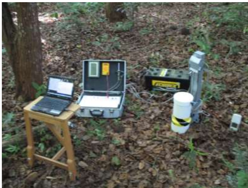
FIGURA 15. EQUIPAMENTO INSTALADO, COMPONENTES INTERLIGADOS: COMPUTADOR, BATERIA, MALETA E CÂMARA.
