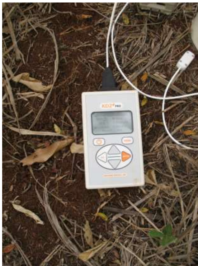
FIGURA 19. EQUIPAMENTO KD2 - PRO ACOPLADO AO SENSOR TH1 EM COLETA DE DADOS NO TALHÃO 15.
