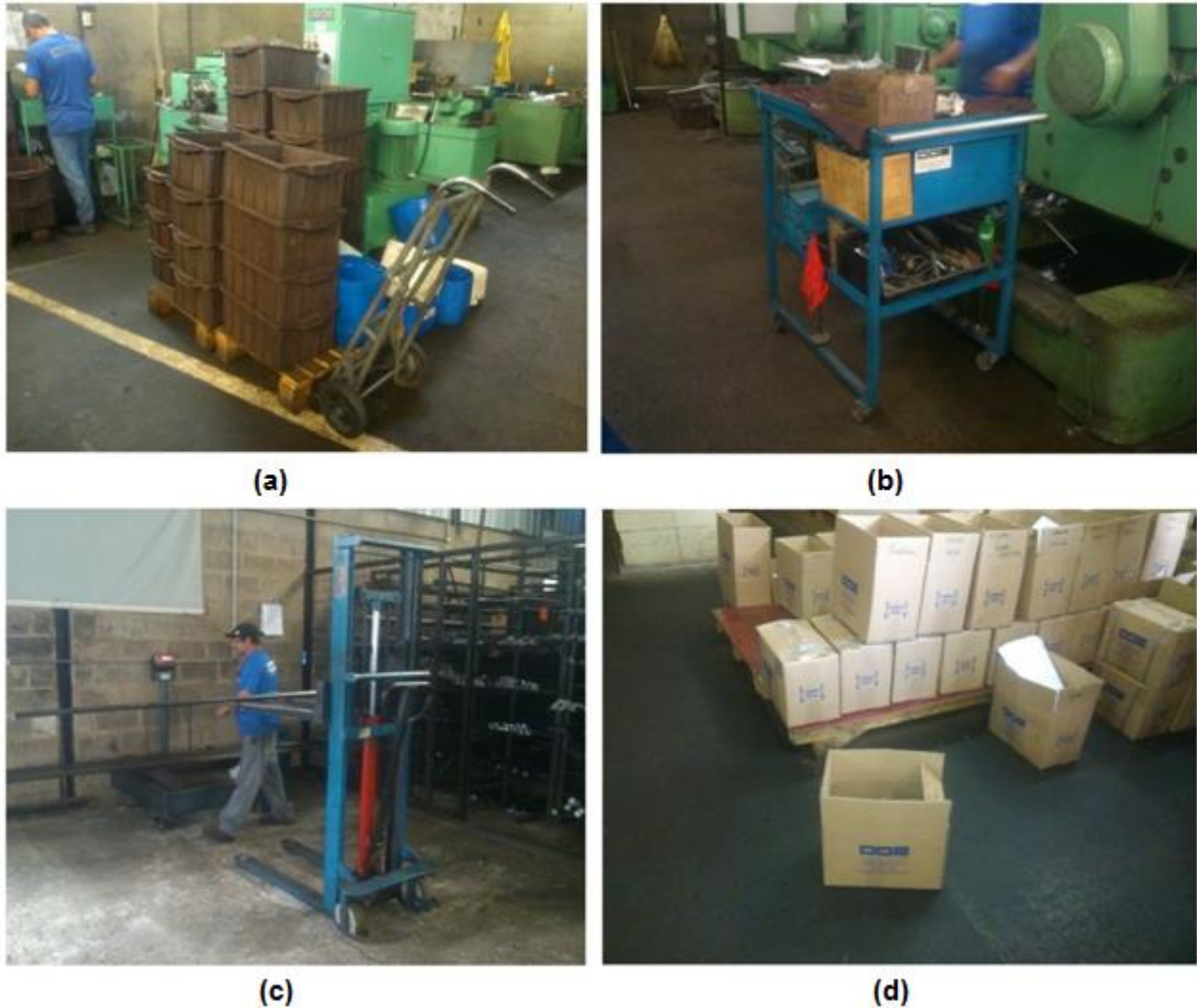
Figura 5.4: Obstáculos de maior frequência no ambiente dinâmico 1: (a) carro de transporte de caixas; (b) carro de transporte de ferramentas; (c) empilhadeira manual e (d) caixas para produto final
