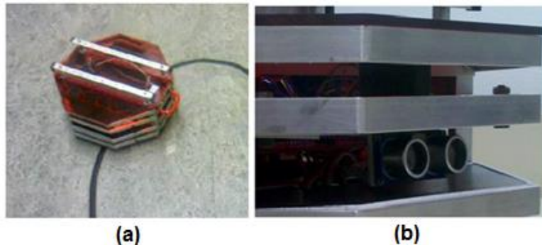
Figura 3.14: (a) Robô utilizado para o sistema de transporte de material automatizado (AMTS sigla em inglês) - (MATSUMURA, 2014) (b) disposição do sensor ultrassônico
