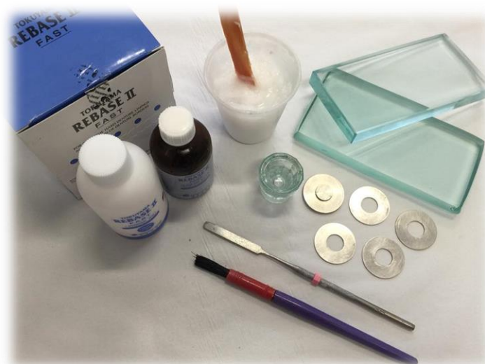
Figura 4 - Materiais usados para confecção de corpos de prova com resina para reembasamento.
