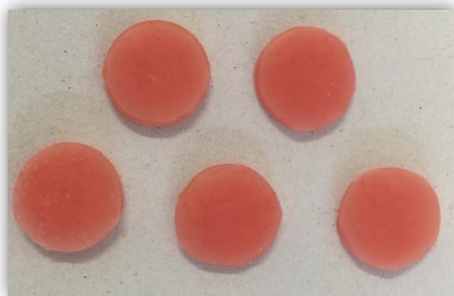
Figura 3 – Corpos de prova de resina acrílica termopolimerizável para base de prótese.
