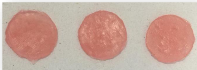
Figura 6 - Corpos de prova de resina para reembasador.
