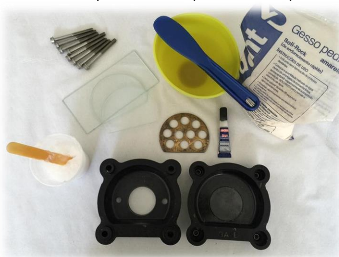
Figura 1 – Materiais usados para confecção de corpos de prova com resina acrílica termopolimerizável para base de prótese.
