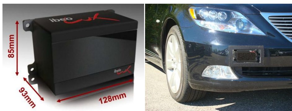
Figura 15: Ibeo LUX 2010 com suas dimensões; e Ibeo LUX instalado em veículo terrestre para direção autônoma.
