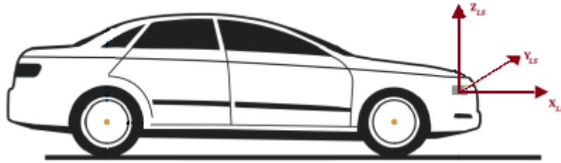
Figura 35: Orientação recomendada do sistema da unidade LASER em veículos.
