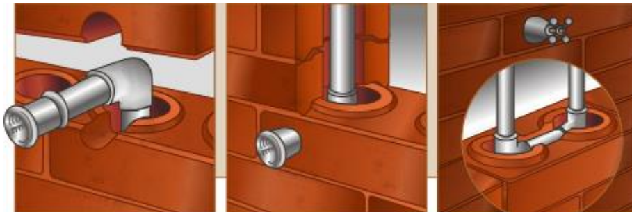
Figura 58 - Instalações hidráulicas em paredes de tijolos ecológicos
