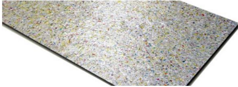
Figura 51 - Placa a ser utilizada como forma, produzida a partir de tubos de pasta de dente
