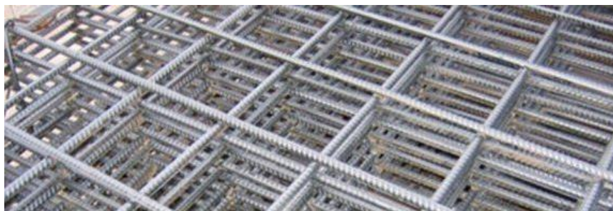
Figura 52 - Tela soldada de aço
