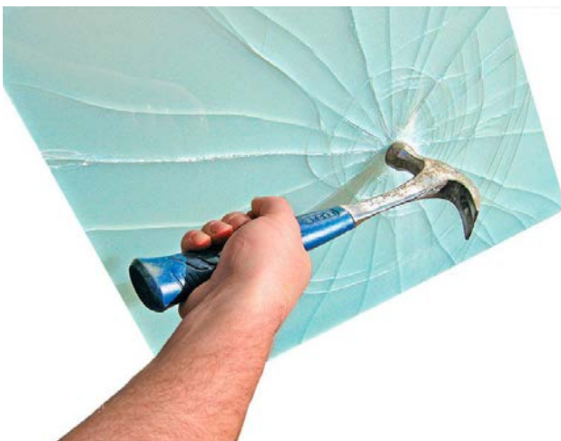
Figura 5– Exemplo de união do vidro ao PVB
