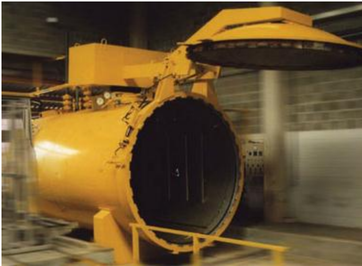
Figura 3– Autoclave para o processo de laminação de vidro
