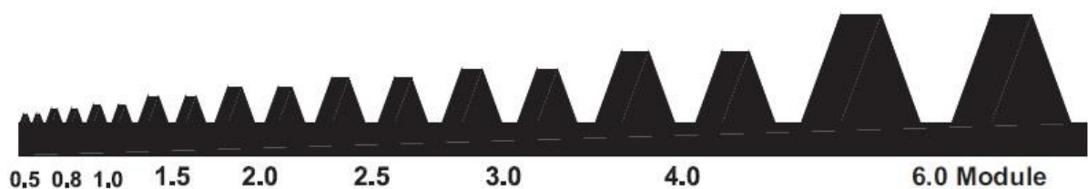
Figura 18 - Representação dos dentes da engrenagem através do módulo
