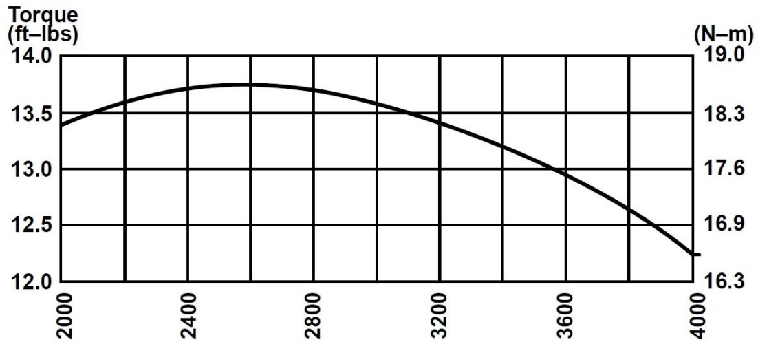
Figura 15 – Gráfico torque x rotação do motor Briggs & Stratton Intek Pro ® 10 hp
