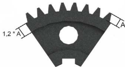
Figura 19 – Redução de massa na alma da engrenagem
