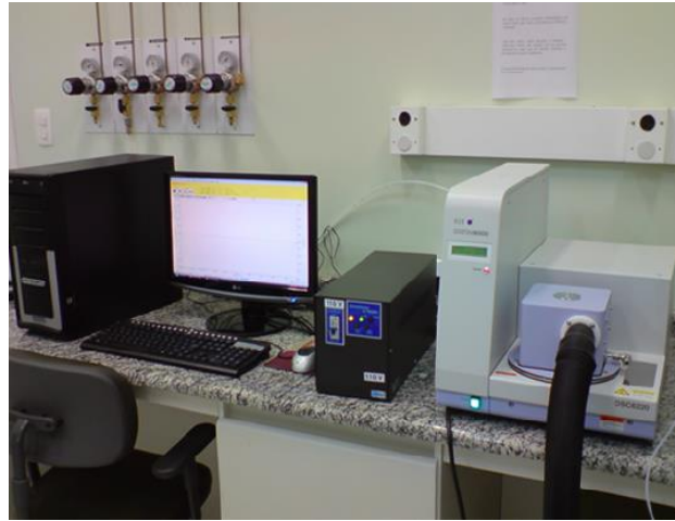
Figura 15 Equipamento DSC SII Nanotechnology SEIKO, modelo 6220.
