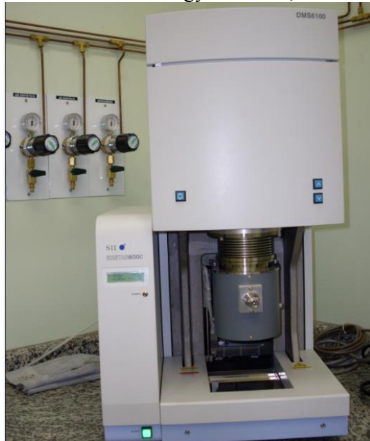
Figura 17 Equipamento SII Nanotechnology - SEIKO, modelo EXSTAR DMS 6100.
