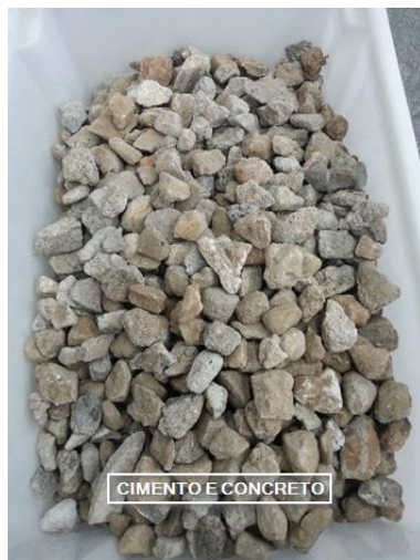
Figura 8 - Amostra separada em cimento e concreto
