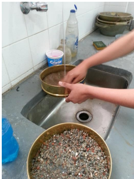
Figura 19 - Lavagem da amostra de areia
