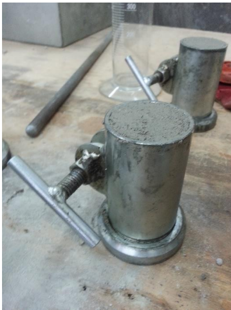
Figura 27 - Molde preenchido e realizado a rasadura
