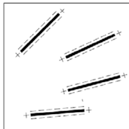
Figura 18 – Lama agitada adquire uma consistência fluida, rompendo-se as ligações elétricas
