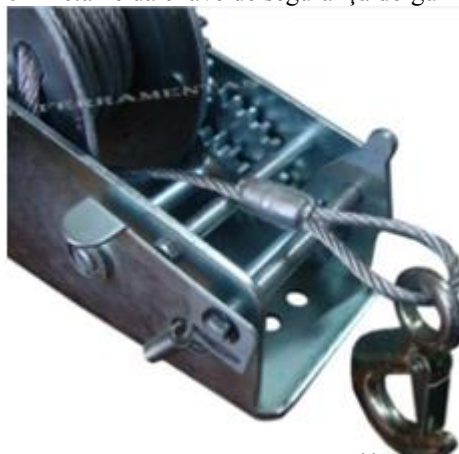
Figura 20 - Detalhe da chave de segurança do guincho manual
