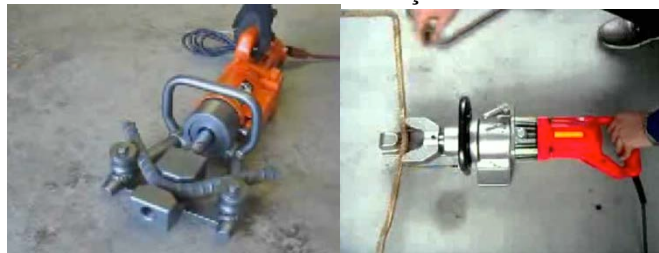
Figura 11 - Exemplo de tecnologia moderna utilizada na construção civil - Máquina para dobrar armadura de aço
