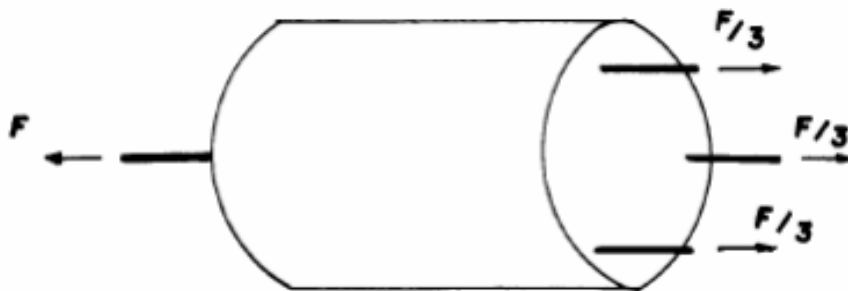
Figura 17 - Esquema do corpo de prova do ensaio de quatro barras.
