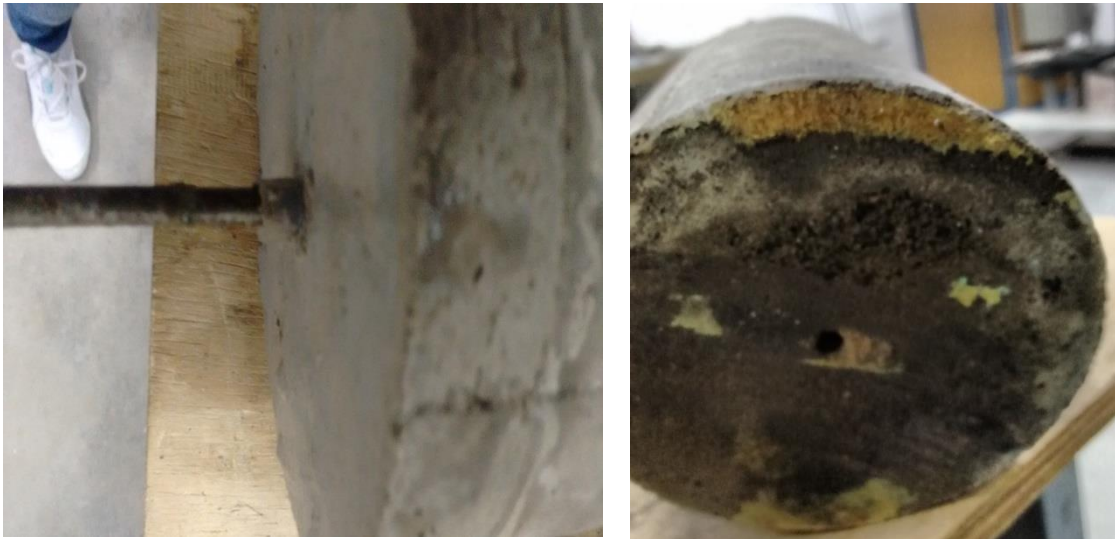
Figura 39 - Terceiro Ensaio, Deslizamento das peças.
