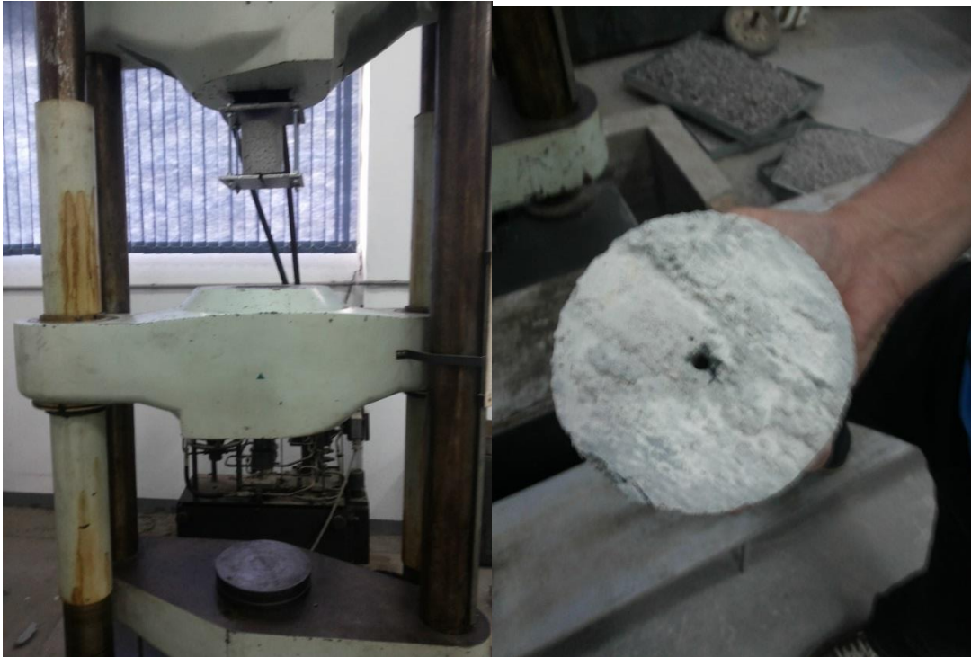
Figura 35 - Primeiro ensaio, peça sem a barra.
