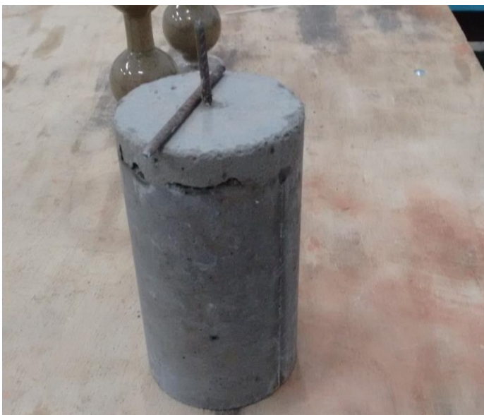
Figura 40 - Terceiro ensaio, Barra Rompida.
