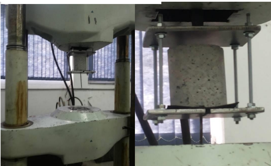
Figura 26 - Ensaio de arrancamento.
