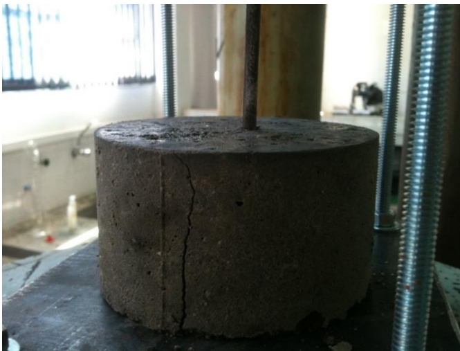
Figura 36 - Segundo Ensaio, Peças trincadas.
