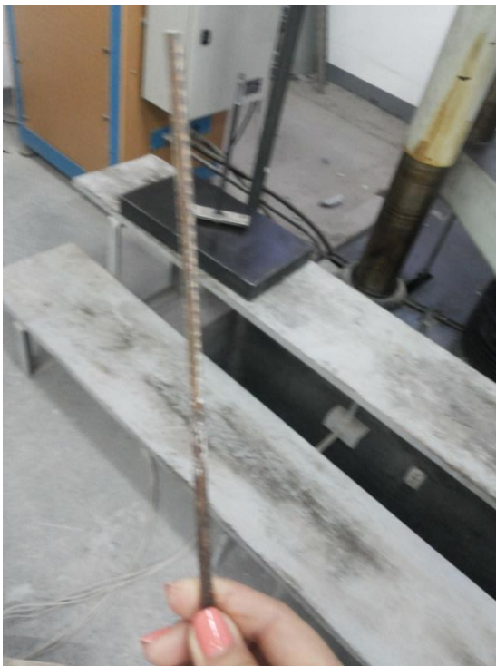
Figura 34 - Primeiro ensaio, barra não aderida à peça.
