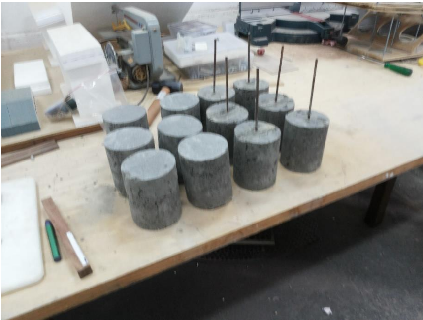
Figura 21 - Corpo de prova, ensaio de tração e de arrancamento.
