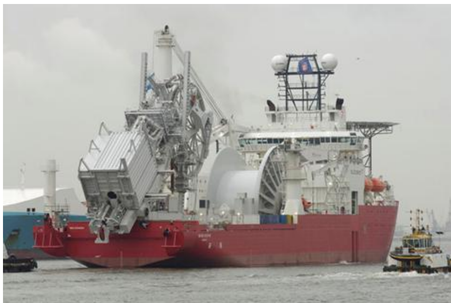
Figura 3: Navio utilizado no lançamento de dutos pelo método carretel.
