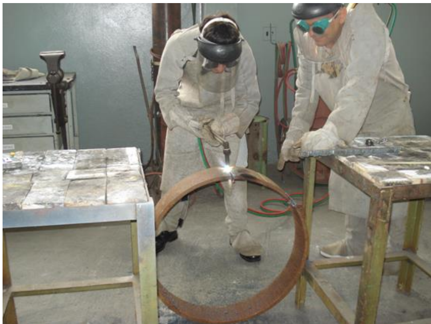
Figura 16: Oxiorte do anel feito com o aço API 5L X70
