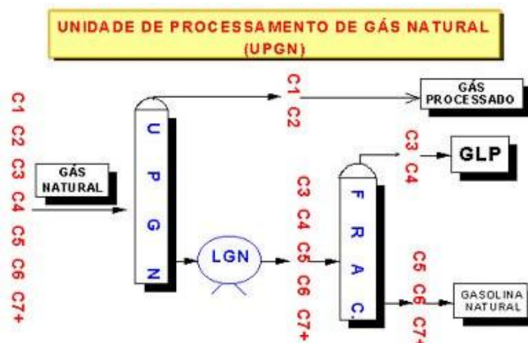
Figura 2.3 – Esquema de funcionamento de uma UPGN.
