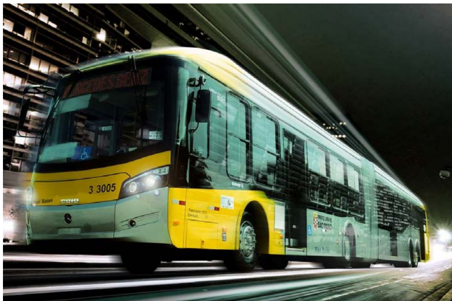
Figura 3.4 – Ônibus Millenium BRT superarticulado fabricado pela Caio Induscar.
