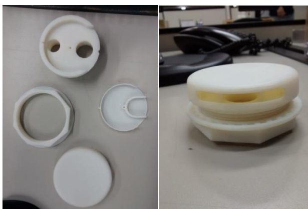
Figura 17 - Conjunto impresso por uma impressora 3D. À esquerda vemos seus componentes e a direita, a montagem.
