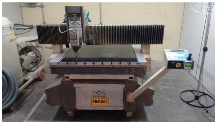
Figura 12 - Fresadora a comando CNC Vitor Ciola utilizada, modelo Sculptor 1211, utilizada para a confecção do modelo de madeira.
