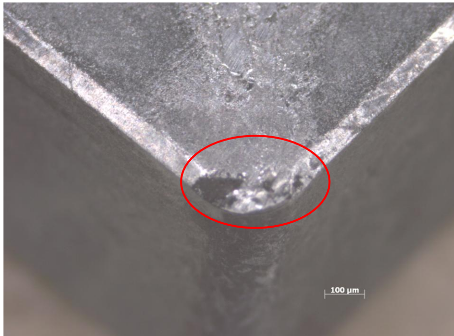
Figura 25 – Deteriorização causada pelos parâmetros V_c = 500\text{m/min} , f = 0.10\text{mm/volta} e a_p = 0.5\text{mm}
