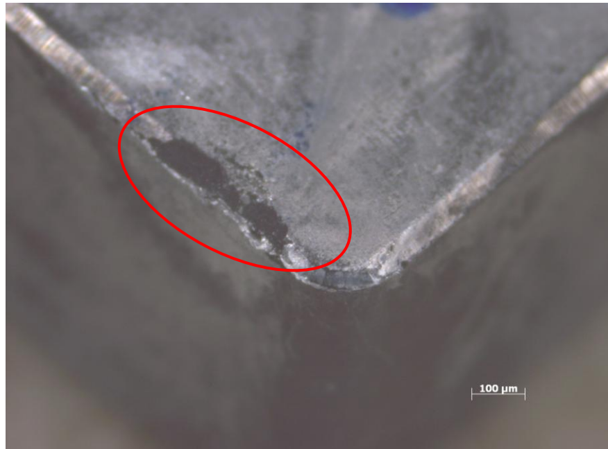
Figura 29 - Deteriorização causada pelos parâmetros V_c = 1000\text{m/min} , f = 0.15\text{mm/volta} e a_p = 0.7\text{mm}
