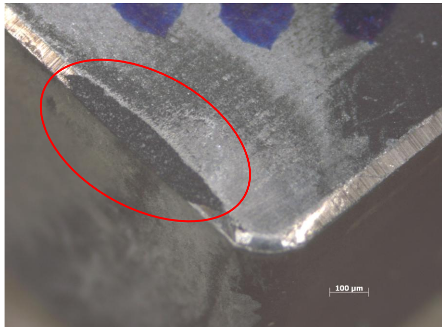
Figura 27 – Desgaste causado pelos parâmetros V_c = 1000\text{m/min} , f = 0.2\text{mm/volta} e a_p = 0.5\text{mm} .
