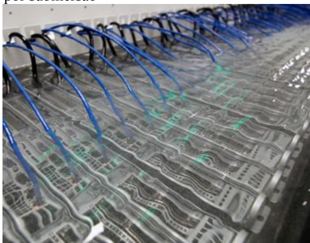
Figura 4.1 Resfriamento por submersão
