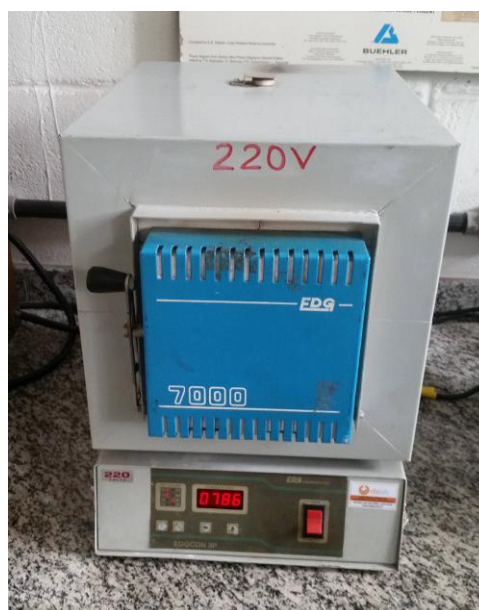
Figura 9 - Forno EDG 7000 da FEG/Unesp utilizado para os tratamentos térmicos.
