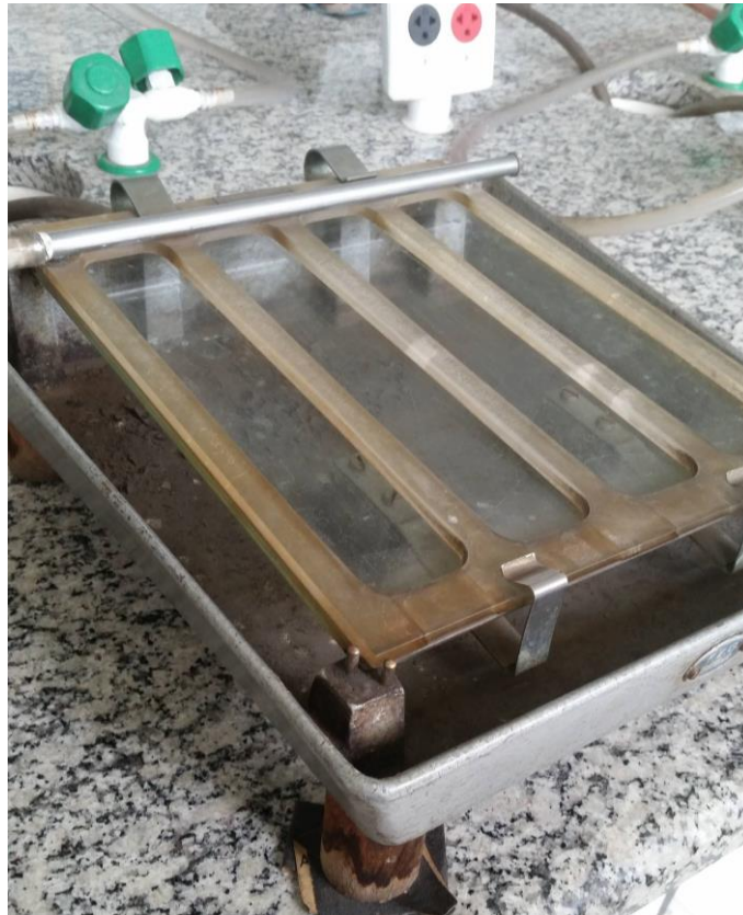
Figura 16 - Sistema de enxágue contínuo na etapa de lixamento.
