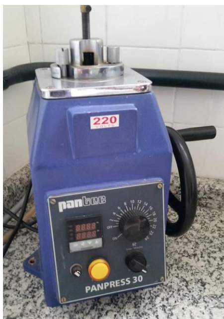
Figura 15 - PANPRESS 30, utilizado na etapa de embutimento.
