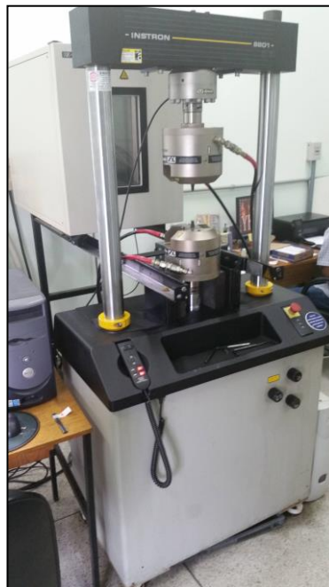
Figura 18 - Ensaio Universal modelo INSTRON 8801 utilizado no ensaio de tração.
