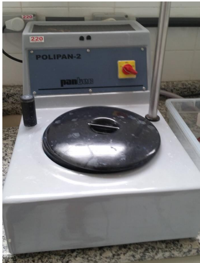
Figura 17 - POLIPAN-2, da PANTEC, equipamento usado no polimento.
