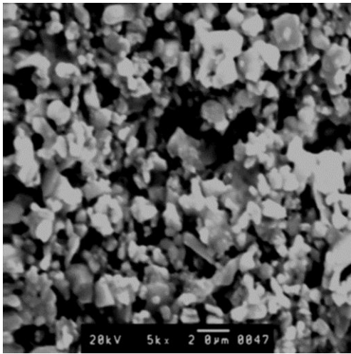
Figura 17 - MEV das fitas a verde obtidas por tape casting , (a) Am1, (b) Am2, (c) Am3 e (d) Am4.
