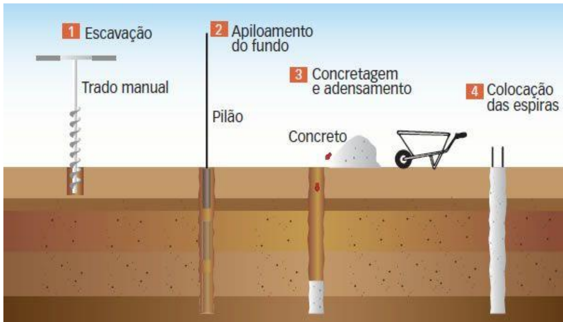
Figura 5 - Processo de execução da broca
